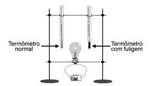
No início, os dois termômetros marcavam 20°C. Ao acender a lâmpada, a temperatura dos dois termômetros foi aumentando, conforme a tabela:
